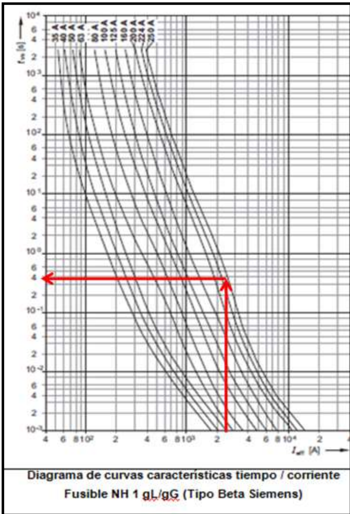
Fig. II-5- Diagrama de curvas características tiempo/corriente.
