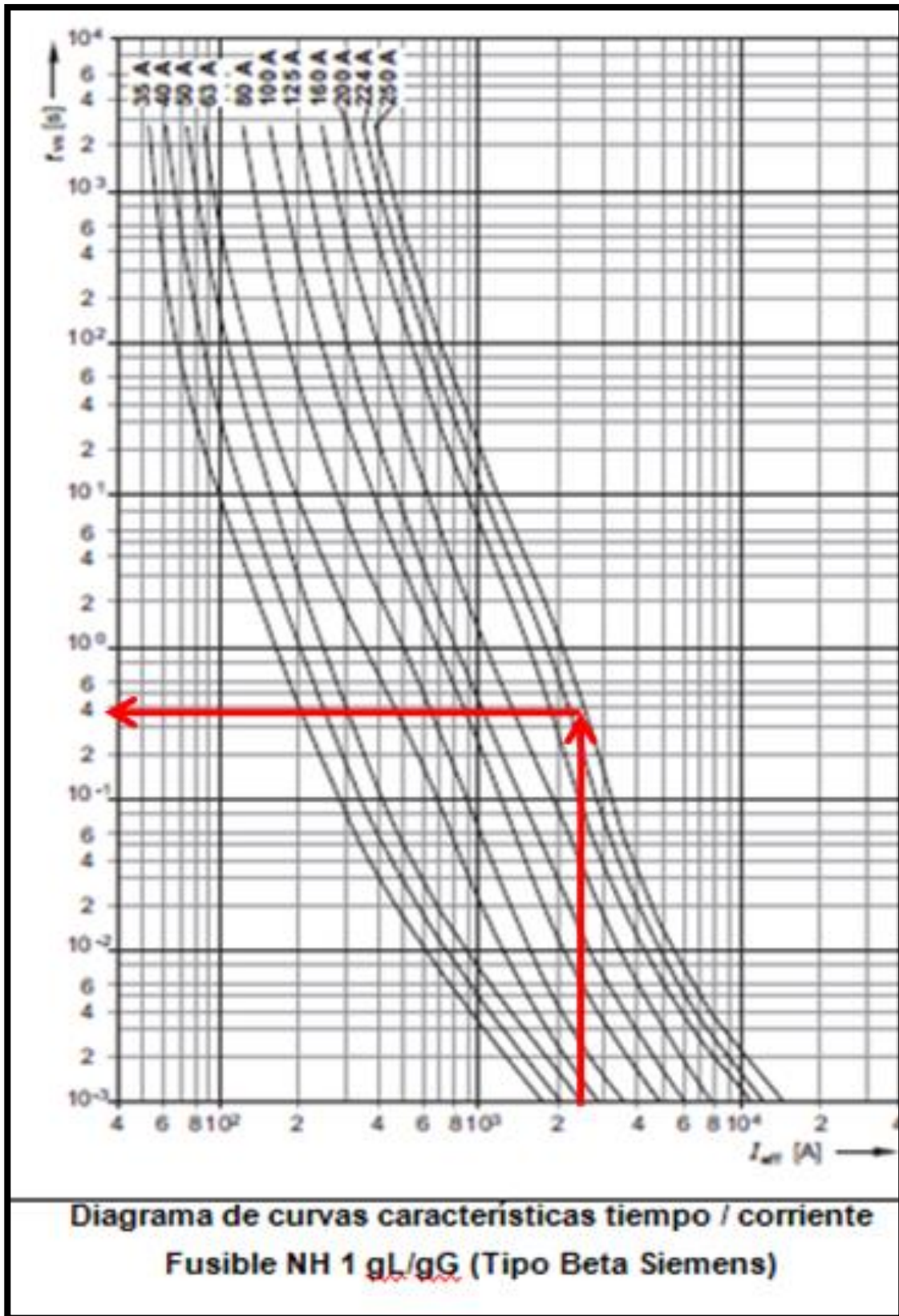
FIG. 29- Diagrama de curvas características tiempo/corriente.
